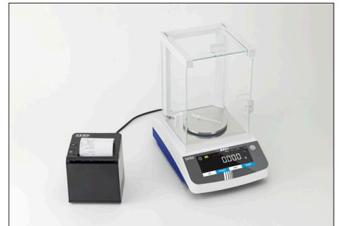
In einem GLP-konformen Druckprotokoll lassen sich alle Wägewerte dokumentieren, einschließlich Datum, Uhrzeit und Ident-Nr.
